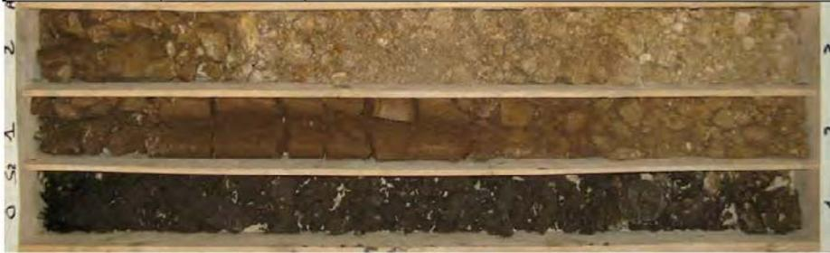
**Figura 3:** Sondaggio Superficiale da 0. a -3 metri
